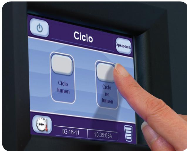
La unidad V-PRO 1 Plus requiere únicamente electricidad para la instalación. No se necesitan otros servicios: ni agua, ni vapor, ni aire comprimido, ni ventilación, ni drenajes. Esto hace que la instalación sea simple, rápida y práctica para el hospital y reduce a un mínimo los costes de instalación, uso y mantenimiento.
